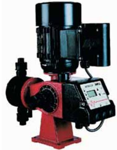
Bei den motorisch angetriebenen Dosierpumpen lässt sich außerdem die Drehzahl des Motors mit einem Frequenzumrichter regulieren. Auch eine elektrisch betriebene Fernverstellung der Hublänge ist möglich, wobei die Wahl zwischen einer 3-Punkt-Schritt-Steuerung oder Gleichstrom-Normsignal besteht.
