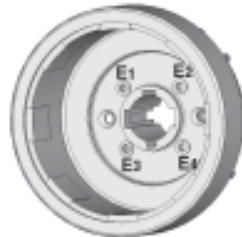
Bild 8.3.1 D - Schraubenreihenfolge E1 - E2 - E3 - E4
