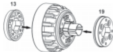
Bild 8.3.2 B Montage der Klemmringe
