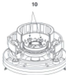
Bild 8.1.2 G - Demontage des Magnetantriebs
