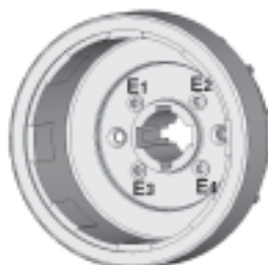
Fig. 8.3.1 D - Screw repeating the sequence E1 - E2 - E3 - E4
