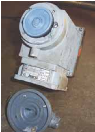
Das Foto zeigt die zerstörte Magnet-Membran-dosierpumpe MAGDOS.
