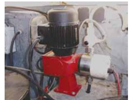
Sonderbau MEMDOS mit beheiztem Dosierkopf ist nun im Einsatz
